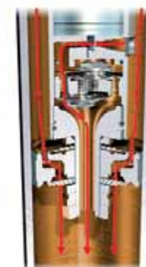
Phase de détente – Piston moteur et by-pass = réglage sportif-confortable
