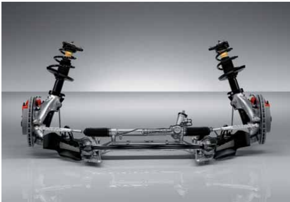
Essieu avant McPherson avec bras triangulaires et jambes de force du Cayman S
