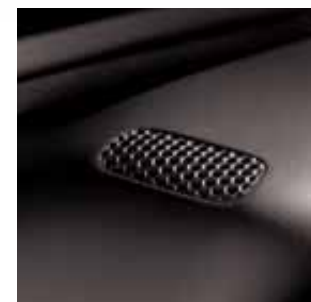
Microphone pour AudioPilot™ intégré dans la colonne de direction
