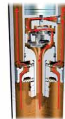
Phase de compression – Piston et by-pass = réglage sportif-confortable
