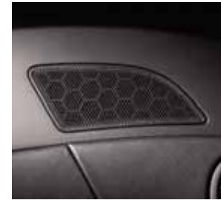
Enceinte Néodyme 2,5 cm pour les fréquences aiguës
