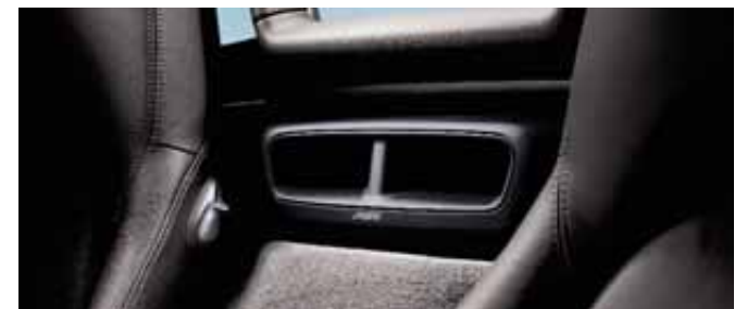
Subwoofer actif avec respectivement 2 HP 13,0 cm pour les graves et 2 HP 6,5 cm médium-aiguës
