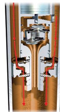
Phase de détente – Piston seul = réglage sportif plus ferme
