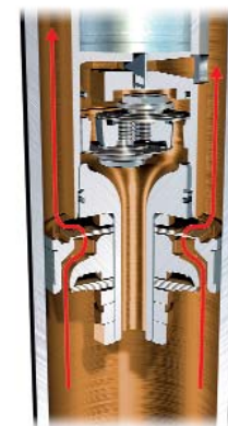
Phase de compression – Piston seul = réglage sportif plus ferme
